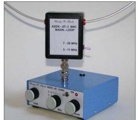
Bild 2: KW-Empfang mit ADDX Schleifenantenne
