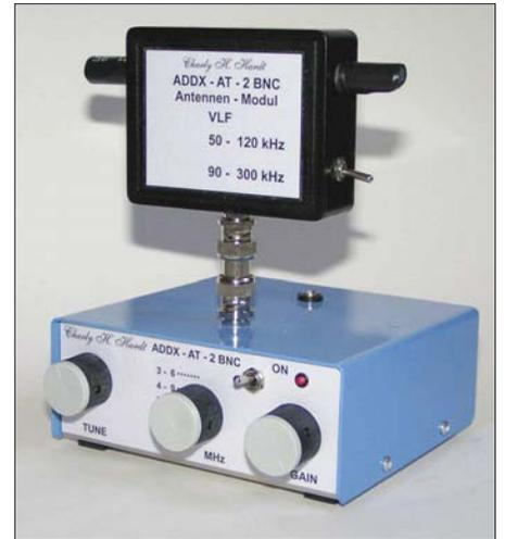
**Bild 8: ADDX-Verstärkermodul mit VLF/LW-Ferritantenne**
